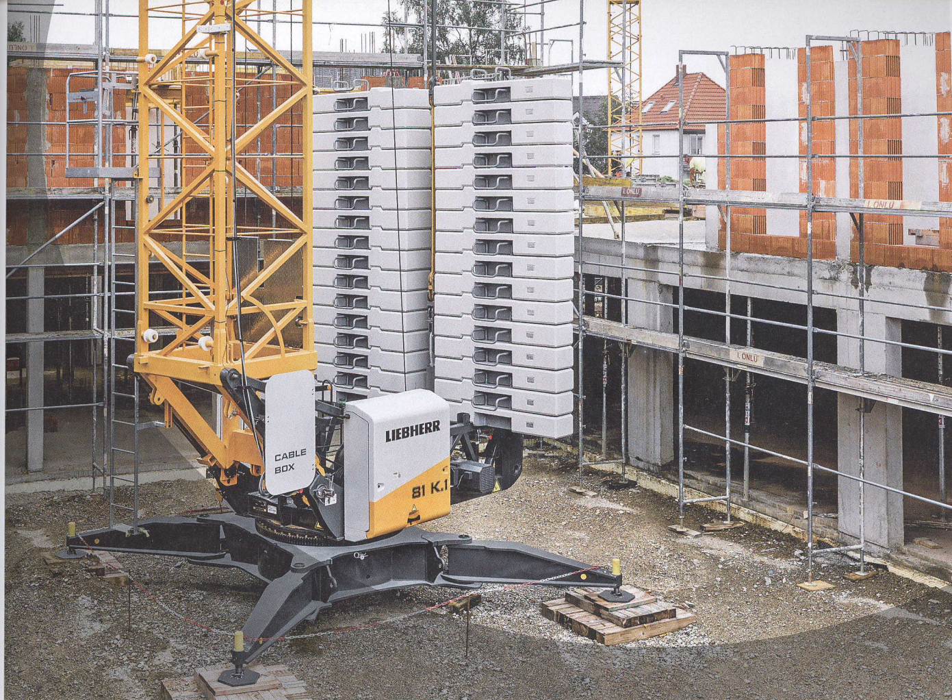
Ballastgewichte im Einsatz auf einem Liebherr-Hochbaukran.
